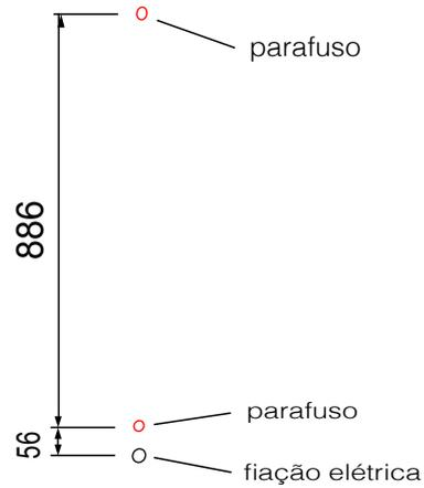
Passo 2: Coloque a bucha. Ao aparafusar, deixe uma sobra suficiente para ser utilizada como suporte para o encaixe da luminária.
