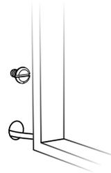
Passo 4: Encaixe os dois suportes de fixação da luminária utilizando os parafusos, como ilustrado. Certifique-se de que o encaixe está firme.
