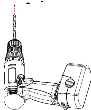
Passo 2: Faça os furos no teto. O furo central será a passagem da fiação elétrica.
