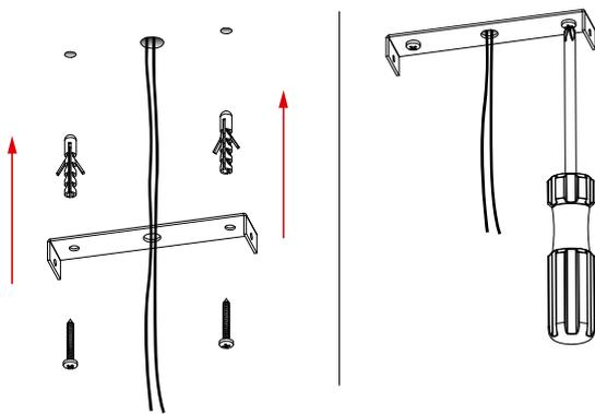
Passo 3: Insira a bucha nos furos laterais e utilize os parafusos para prender o componente da canopla no teto, como ilustrado.
