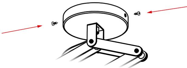
Passo 5: Fixe a canopla no componente utilizando os parafusos, como ilustrado.
