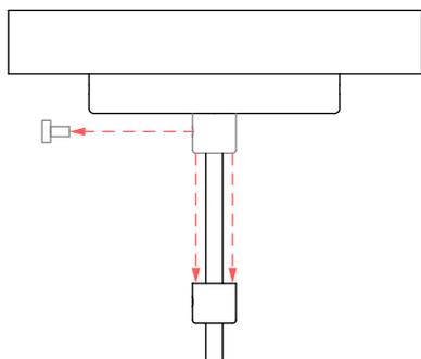
1- Solte o parafuso Allen que prende o cabo à cúpula, após soltar deixe a peça descer até a base da luminária
