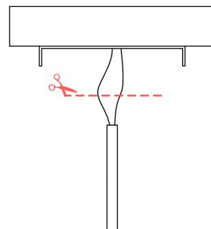
3 - Desligue a energia da luminária e depois desfaça a junção dos fios elétricos.
