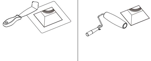
Emasse o teto em volta da peça para dar início ao acabamento. Depois de seco, pinte o teto;
