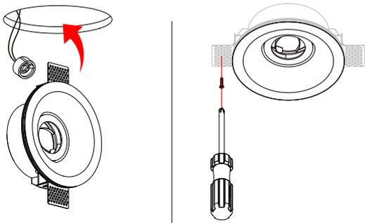
Faça o corte no tamanho indicado e encaixe a peça no teto. Para fixar a peça, aparafuse-a usando as garras laterais;
