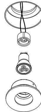
3 - Insira a **peça externa**. Uma vez a peça encaixada e alinhada com a superfície do teto, use parafusos para fixar, emasse a parte de fora fazendo o acabamento e espere cerca de 1 hora até o gesso secar.
