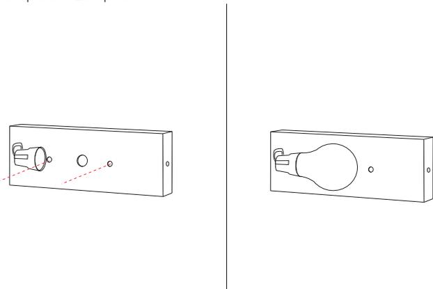
Passo 3: Uma vez que a base esteja fixada na parede, encaixe o corpo da peça;
